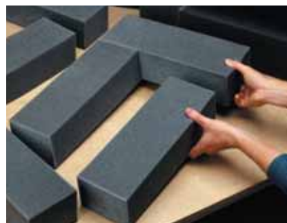
Lepení dvou pěnových materiálů v nábytkářském, automobilním aj. průmyslu. Lepidla jsou vhodná i pro lepení tkaniny na jádra ze skelných a minerálních vat.
