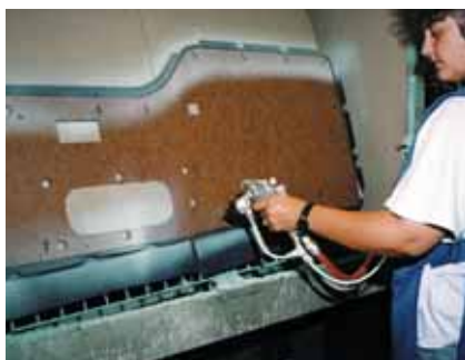
Lepení pěnových hmot ke dřevu, plsti, oceli, dřevovláknité desce a jiným materiálům.
