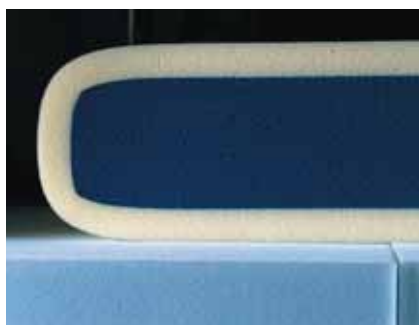
Lepení dvou pěnových materiálů v nábytkářském, automobilním aj. průmyslu. Lepidla jsou vhodná i pro lepení tkaniny na jádra ze skelných a minerálních vat.
