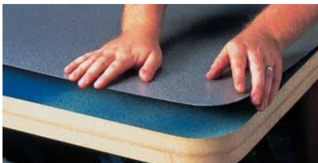
Lepení laminátu na dřevotřískové jádro.
